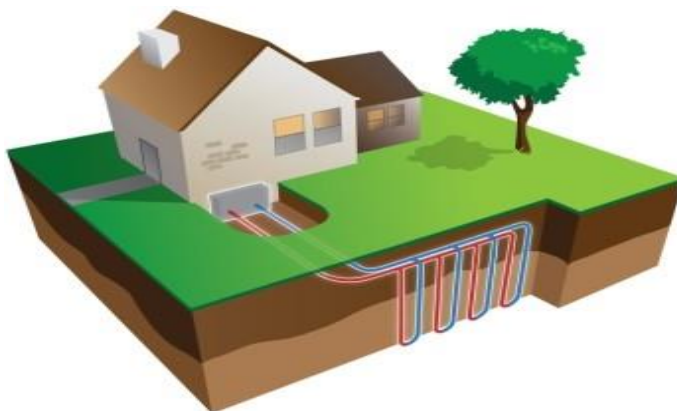
Figure 10 : Schéma avec plusieurs sondes géothermiques
