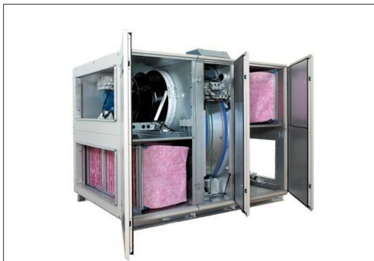
Figure 13 : Centrale de traitement d'air avec échangeur rotatif 85 %
